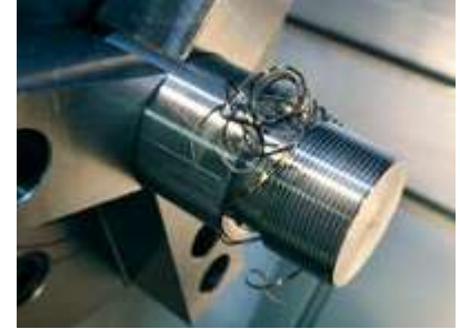
Esempio di intasamento dei trucioli
